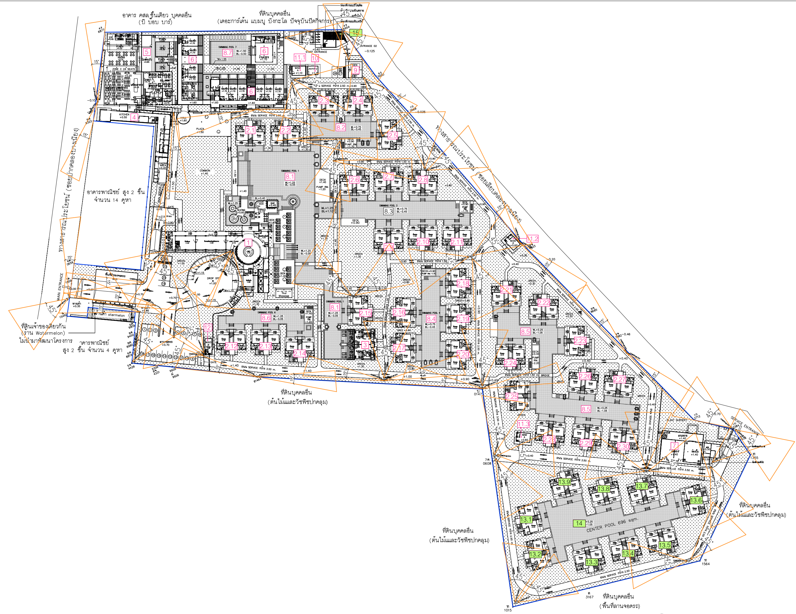
รูปที่ 2-46 ผังแสดงตำแหน่งติดตั้งกล้องวงจรปิดภายในโครงการ
